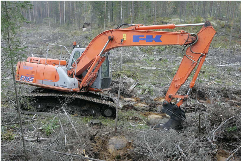
Рис. 1.14. Покровосдираание с созданием микроповышений подходит при создании ели и березы на минерализованных почвах (фото НИИ леса Финляндии)
