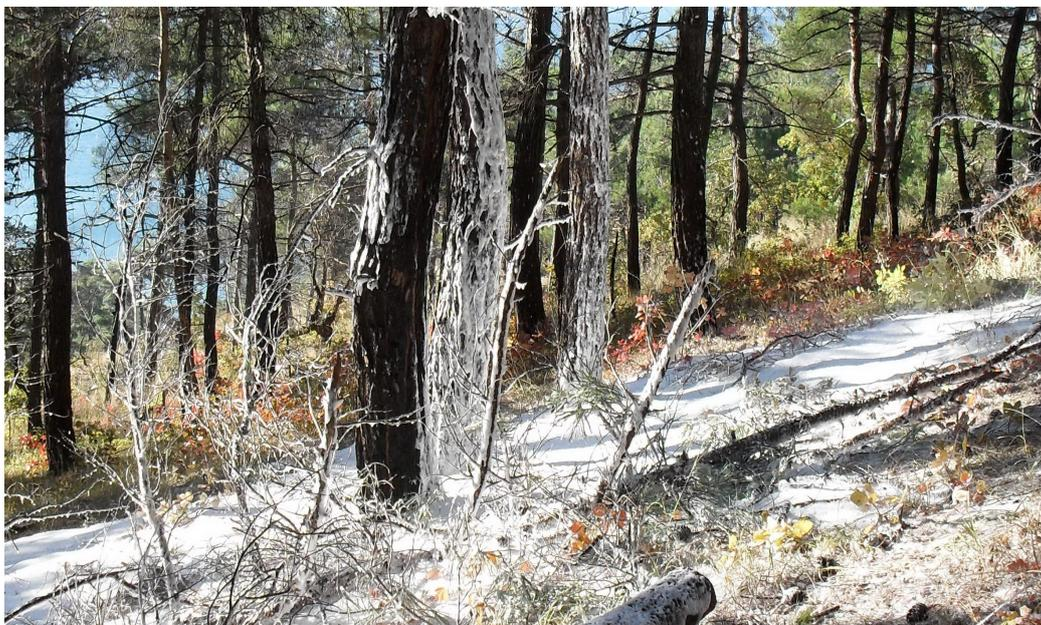
Рис. 4. Характерная пенная "дорожка" при сливе из ВСУ-5А раствора Файррекс (0,67 %) на сосняки
