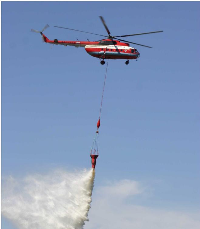
Рис. 3. Вертолет Ми-8Т с ВСУ-5А и системой СДП-1
